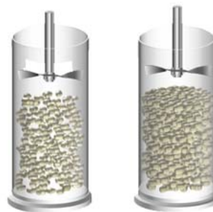
تصویر شماره ۲: سیستم بررسی میزان پرس پذیری پودرهای فرمولاسیون‌های طراحی شده.
