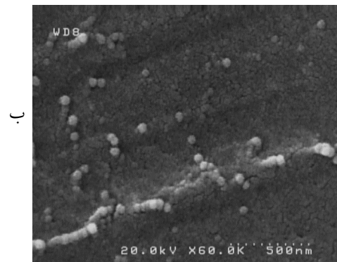
تصویر شماره 2: طیف جذبی نانوذرات طلای سنتز شده در گستره فرابنفش-مرئی (شکل بالا) و تصویر FESEM نانوذرات سنتز شده
