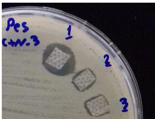
تصویر شماره ۱: روش انتشار در آگار برای بررسی خاصیت ضد میکروبی
