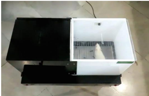
تصویر شماره ۲: دستگاه شاتل باکس برای سنجش خاموشی ترس
