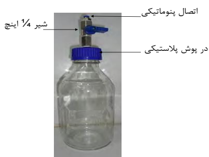
تصویر شماره ۱: هاضم بی هوازی با جریان هیدرولیکی ناپیوسته
