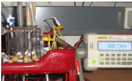
تصویر شماره ۱: راکتور ACMDC و دستگاه ثبت داده های مورد استفاده در تحقیق
