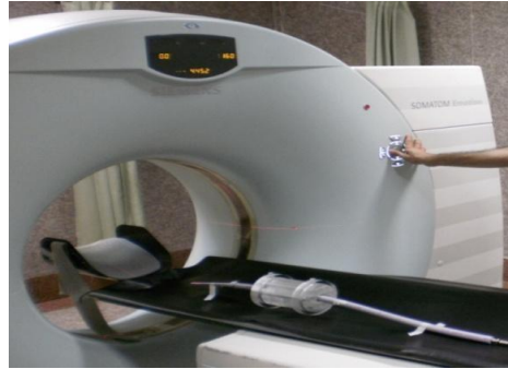
تصویر شماره ۲: تهیه تصاویر سی‌تی اسکن از فانتوم استوانه‌ای مورد استفاده در این پژوهش به همراه اپلیکاتور قرار گرفته در محل
