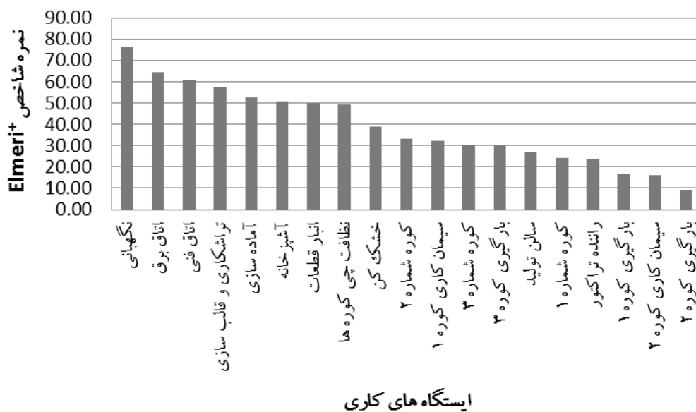
نمودار شماره 1: نمره کل شاخص Elmeri + در ایستگاه‌های مختلف کاری کارخانه تولید سفال
