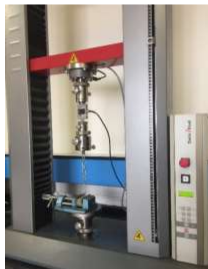
تصویر شماره ۴: نمونه ای که به دستگاه Universal Testing Machine متصل شده است
