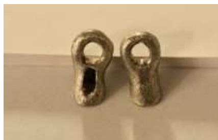
تصویر شماره ۳: نمونه های ساخته شده. فاقد حفره دسترسی (راست) - دارای حفره دسترسی (چپ)
