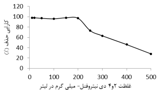
نمودار شماره ۴: تاثیر غلظت اولیه ۴و۲ دی نیترو فنل بر فرآیند جذب (pH 5، دوز جاذب ۰/۴ گرم در لیتر و زمان تماس ۱۰۰ دقیقه)
