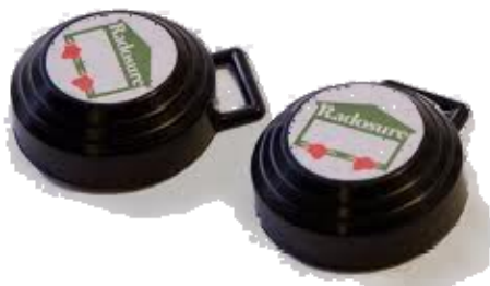
تصویر شماره ۱: آشکارساز جهت اندازه گیری گاز رادون
