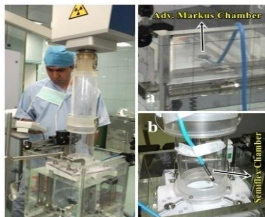
تصویر شماره ۳: (a) دوزیمتر میدان Advanced Markus، (b) دوزیمتر مرجع Semiflex جهت کنترل تغییرات خروجی شتاب دهنده، (c) قرارگیری اپلیکاتور beam shaper در سطح فانتوم آب
