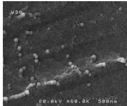
تصویر شماره 2: طیف جذبی نانوذرات طلای سنتز شده در گستره فرابنفش-مرئی (شکل بالا) و تصویر FESEM نانوذرات سنتز شده
