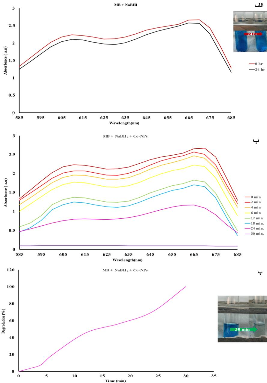
نمودار شماره ۵: الف) میزان رنگبری متیلن بلو در حضور NaBH<sub>4</sub> بدون نانوذرات، ب) فعالیت فتوکاتالیستی نانوذرات در جهت تخریب MB در حضور NaBH<sub>4</sub>، پ) درصد تخریب رنگ MB در گذر زمان در حضور نانوذرات کبالت
