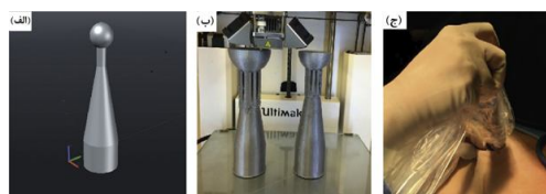
تصویر شماره 7: (الف) تصویری از طراحی رایانه ای برای یک ابزار با اندازه 2/5 سانتی متر. (ب) ابزار اندازه گیری پرتودرمانی حین عمل با ساختارهای پشتیبانی که در محل چاپ می‌شود و در طی فرآیند پردازش از بین می‌روند. (ج) یک ابعاد اندازه گیری 2/5 سانتی متر که در حین عمل استفاده می‌شود.
