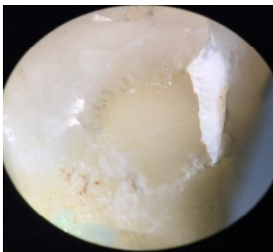
تصویر شماره 3. موقعیت شکست باند برشی: 1) Cohesive failure، 2) Adhesive failure و 3) Mixed failure
