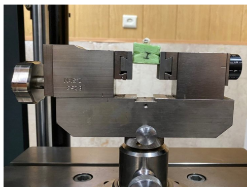
تصویر شماره 2: نحوه قرارگیری نمونه در دستگاه (Zwick/roll 2050) Universal testing machine
