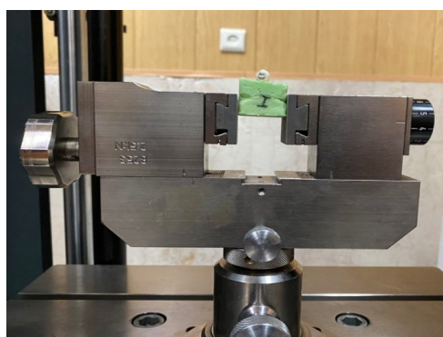
تصویر شماره 2: نحوه قرارگیری نمونه در دستگاه (Zwick/roll 2050) Universal testing machine
