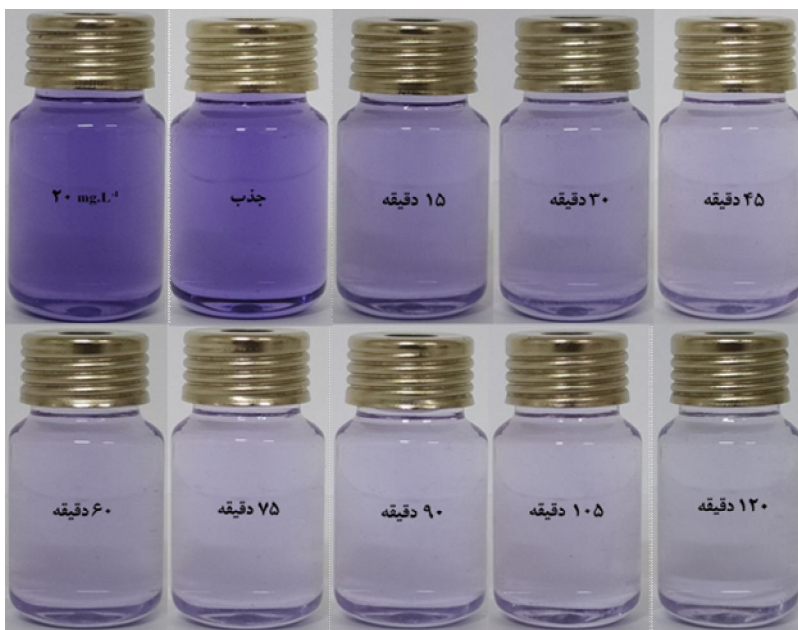
تصویر شماره 4: تصاویر رنگ اسیدبلو 113 قبل و بعد از تخریب فتوکاتالیستی با اکسید روی - کاتولین
