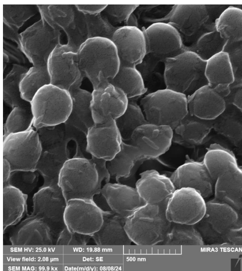
تصویر شماره ۱: مورفولوژی کروی نیوزوم حامل ایمی پنم بر اساس میکروسکوپ الکترونی روبشی گسیل میدانی (FE-SEM)
